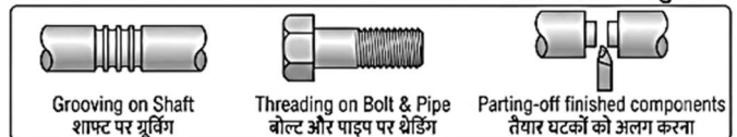
Fig. 16.4: CNC Canned Cycles in Turning Operations | सीएनसी टर्निंग ऑपरेशंस में कैन्ड साइकिल
