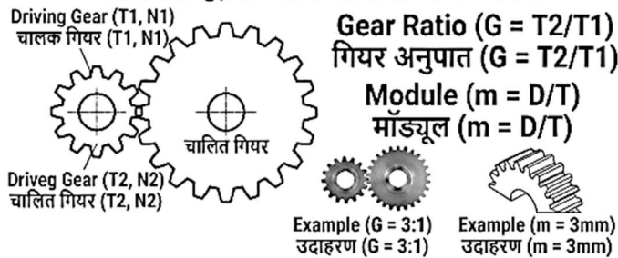
Fig.5.7: Elements and Applications of Spur Gear | स्पर गियर के अवयव एवं अनुप्रयोग
